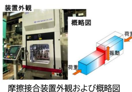
摩擦接合装置外観および概略図
